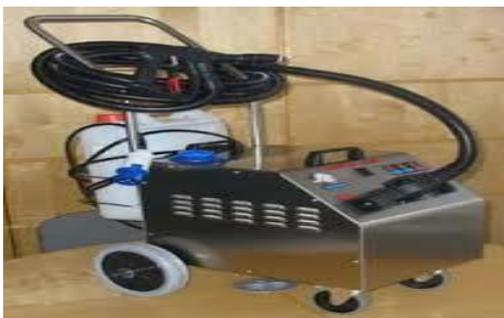
Los equipos móviles son aquellas máquinas que permiten realizar lavados para vehículos de forma manual. “Cuentan con un depósito de agua limpia de 60 litros, otro para escurrir los paños mojados, una lanza pulverizadora regulable, manguera de largo alcance (que permite lavar un vehículo sin necesidad de mover la máquina), una batería de 12V (la misma requiere cargarse sólo 2 o 3
