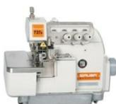
Una máquina para coser "overlock" es un tipo de máquina para coser que se utiliza, tanto a escala industrial como doméstica, para coser y hacer dobladillos, entre otros acabados. Hay diferentes tipos, y todas tienen agujas y dedos que cosen y giran varios hilos para contener los bordes dispares de las costuras, mientras recortan los extremos de las telas.
