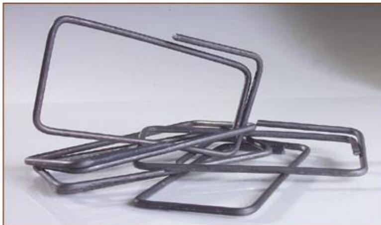
El Estribo es una Armadura perpendicular a las barras longitudinales de una viga de hormigón armado que se coloca como refuerzo para soportar el esfuerzo tangencial o cortante.
