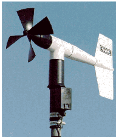
Figura 17. Anemoveleta instalada en las estaciones automáticas de la provincia de Loja. Fuete: Empresa Sistemas Tecnológicos Alcatecni Cia. Ltda..
