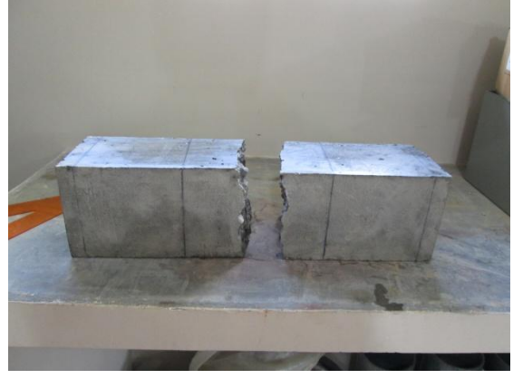
FOTOGRAFÍA 14.- Probeta prismatice ensayada a flexión
