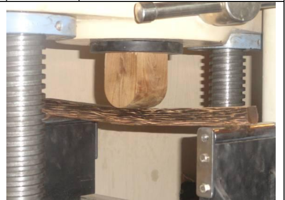
FOTOGRAFÍA 06.- Ensayo de flexión estática de las probetas de pambil
