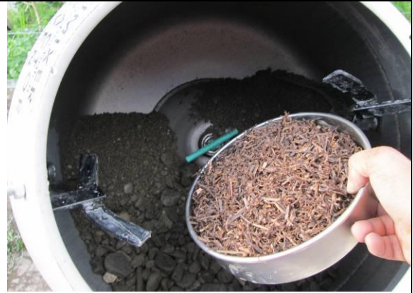
FOTOGRAFÍA 02.- Adición de la fibra al hormigón
