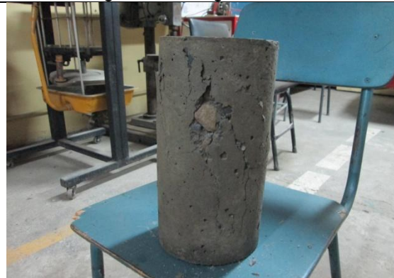
FOTOGRAFÍA 12.- Probeta ensayada a compresión
