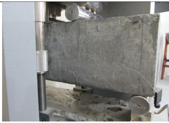
FOTOGRAFÍA 18.- Ensayo de flexión en vigas
