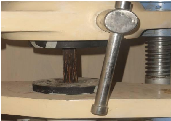
FOTOGRAFÍA 05.- Ensayo de compresión paralela a la fibra
