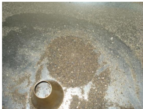
Figura 5.5. Árido fino en estado saturado superficialmente seco. Fuente: Autor de la investigación, 2013
