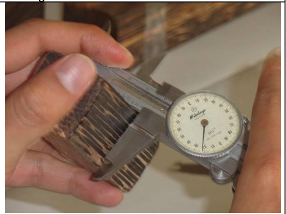
FOTOGRAFÍA 04.- Toma de datos de las probetas de pambil
