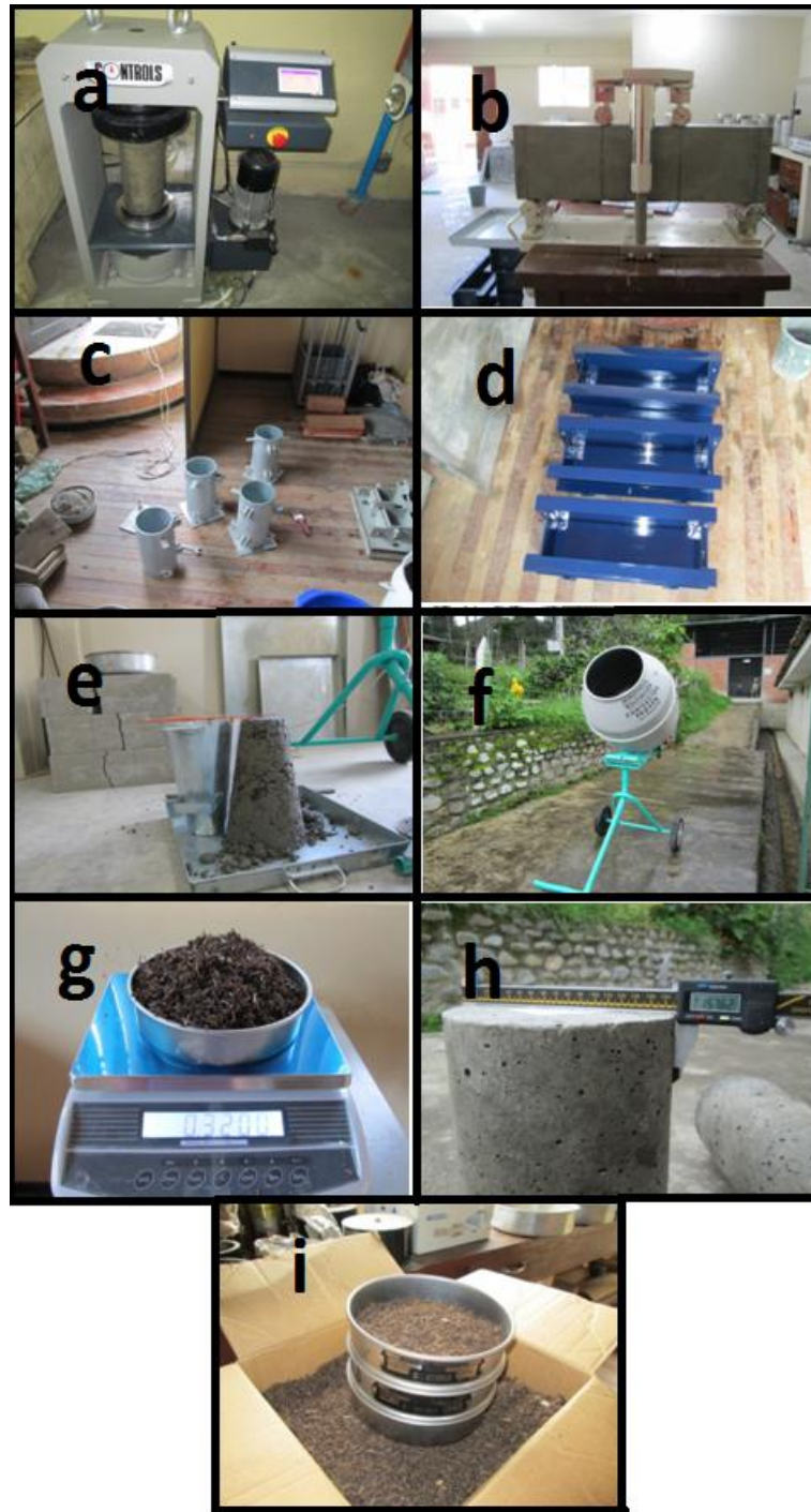
Figura 5.1. Equipo utilizado en laboratorio: a. para ensayo compresión. b. ensayo flexión. c. molde para pruebas de compresión. d. molde para pruebas de flexión. e. cono de Abrams. f. concretera. g. balanza de precisión. h. calibrador. i. tamices para preparación de fibra
