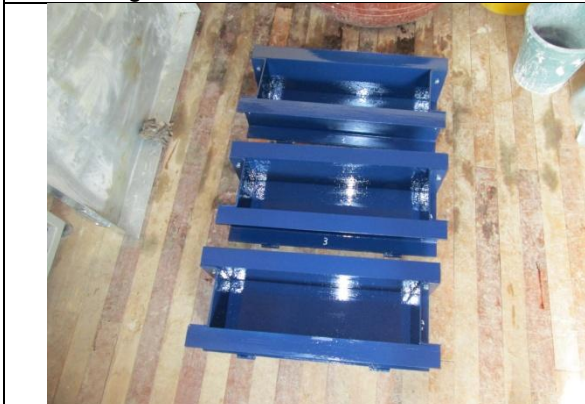
FOTOGRAFÍA 11.- Moldes prismáticos para vigas de hormigón.
