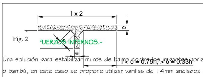
Una solución para estabilizar muros de barro contra los impactos horizontales es utilizar elementos verticales de madera o bambú, en este caso se propone utilizar varillas de 14mm anclados con el sobrecimiento y fijados al encadenado. Los elementos de refuerzo horizontal son poco efectivos e incluso pueden ser peligrosos, debido a que no se puede
