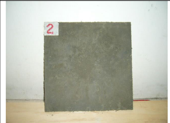
FOTOGRAFÍA 12.- Probeta terminada (dosificación vértice 2)
