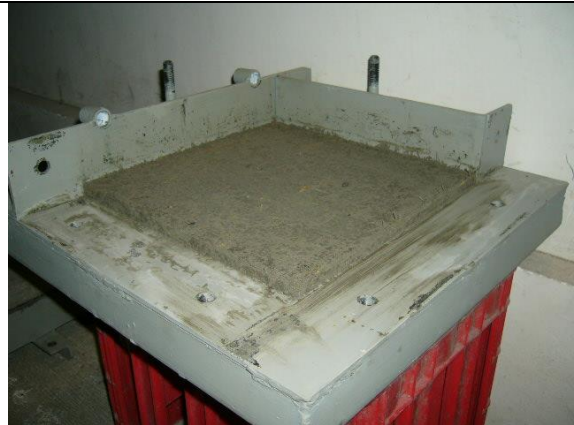
FOTOGRAFÍA 11.- Desencofrado de la probeta
