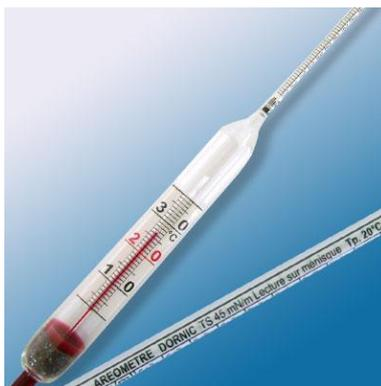
El lactodensímetro o pesa- leche es el instrumento de laboratorio que mide la densidad de la leche, hecho de vidrio, un modelo especial de densímetro, con el vástago graduado de 15 a 40. Flota libremente dentro de la leche, sin tocar las paredes del recipiente, se lee a nivel de la superficie con visual horizontal. Las dos cifras leídas son el milésimo de la densidad y, por tanto, se escriben a continuación de la unidad: 1,0.
