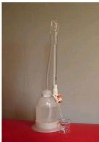
El acidímetro es un instrumento de laboratorio que sirve para medir la acidez de la leche. Este instrumento puede ser de vidrio o plástico.
