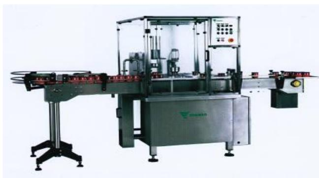
La envasadora que se utilizara para el yogurt en base demora y frutas tropicales será una envasadora automática, versátil diseñada principalmente para la industria láctea, que se adapta a las necesidades específicas del yogur. Esta envasadora tiene las siguientes características:
