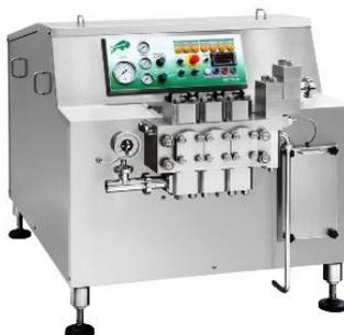
El homogeneizador al igual que el pasteurizador será proporcionado por la empresa ADYNOX S.A, el homogeneizador es un aparato que sirve para mezclar varias sustancias, su nombre lo dice, “homogeniza” es decir mezcla las sustancias que intervienen en la fabricación de yogurt (leche, pulpa de fruta, fermento, azúcar, espesante) y las hace una sola.
