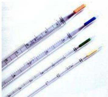
La pipeta es un instrumento volumétrico de laboratorio que permite medir alícuotas de líquido con bastante precisión. Suele ser de vidrio. Está formado por un tubo transparente que termina en una de sus puntas de forma cónica, y tiene una graduación (una serie de marcas grabadas) indicando distintos volúmenes.
