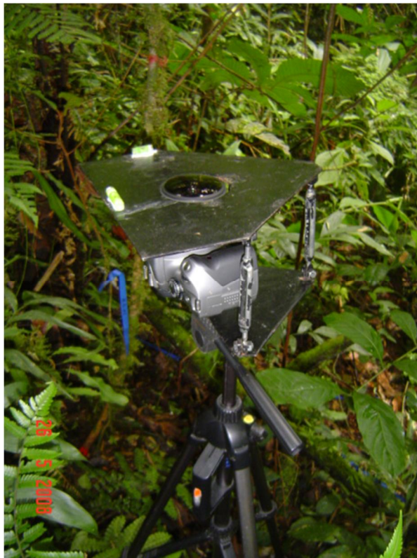
Figura 3. Montaje de la cámara en el trípode para la toma de fotografías hemisféricas.
