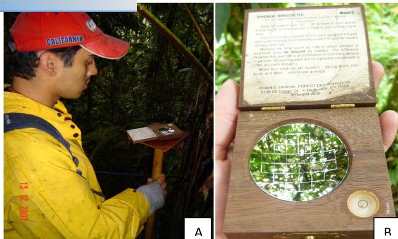
Figura 4. Ubicación del evaluador y del densiómetro esférico. (A) Posición de los evaluadores frente al densiómetro y (B) forma del densiómetro esférico.
