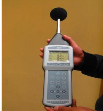
**Figura 6.** Sonómetro de medición OHM 2010
