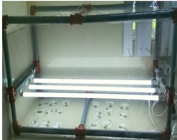
Figura 6. Construcción de 2 incubadoras, para adaptación de los discos de tejido foliar de café variedad típica de 2,5 cm de diámetro, reproducción del fitopatógeno en los discos de hoja de café, colocados sobre papel filtro a una cantidad de agua destilada de 17ml, contenidos en cajas de Petri para asegurar la asepsia.
