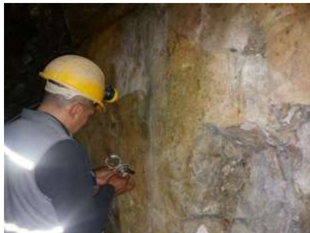
Figura 18. Toma de datos estructurales interior mina
