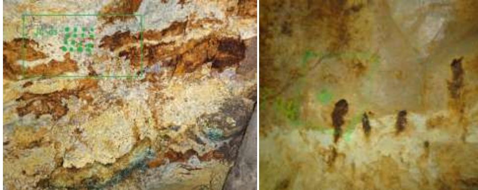
Figura 35: Muestra, de izquierda a derecha, la apariencia de 2 estaciones con distinta calidad geotécnica: mala (JC -2 Crucero Gaby) y una de calidad regular
