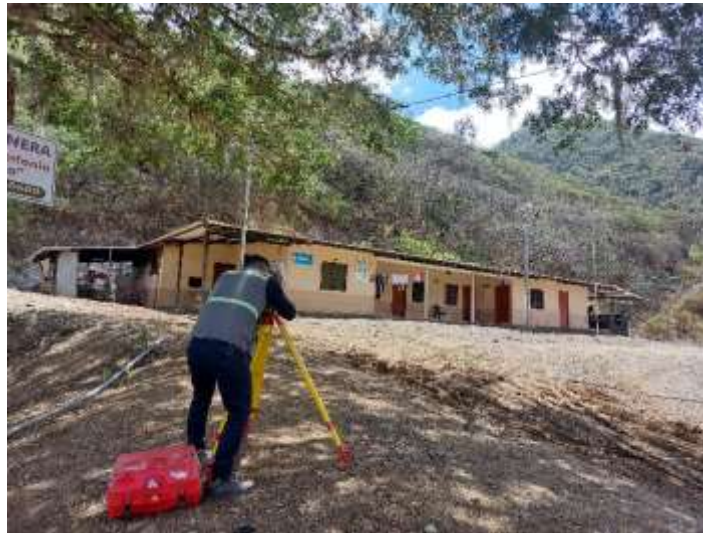
Figura 16. Levantamiento topográfico superficial
