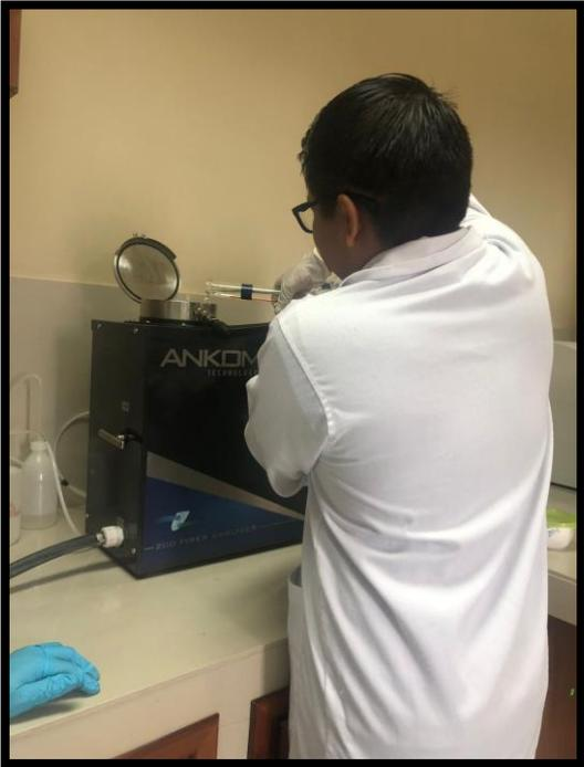
Anexo 9. Determinación de fibra cruda, fibra neutra detergente, fibra ácida detergente utilizando el equipo ANKOM 200 Fiber Analyzer
