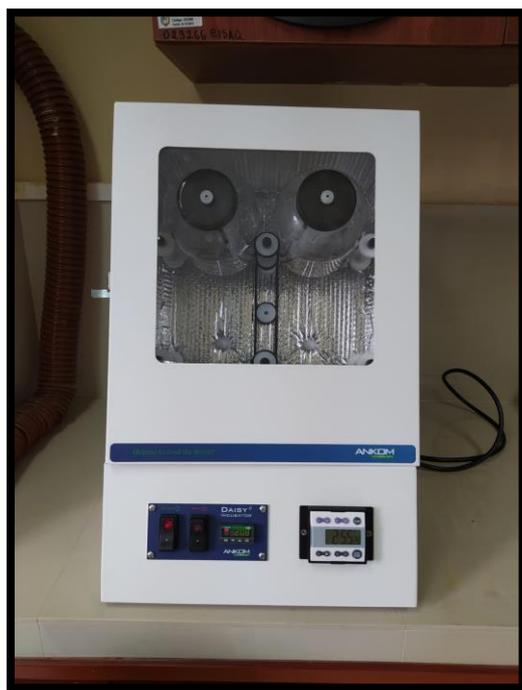
Anexo 10. Determinación de lignina ácida detergente utilizando el equipo ANKOM Daisy<sup>II</sup> Incubator
