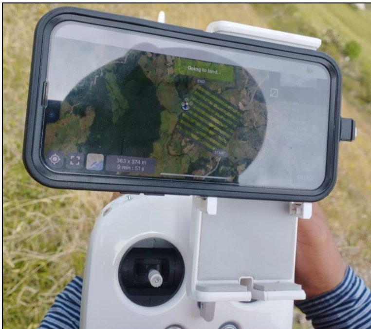
Ilustración 2. Inspección de las líneas de vuelo del Dron
