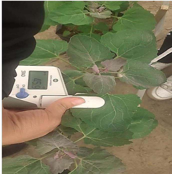
**Anexo 11.** Medición del contenido de contenido de clorofila con el SPAD.
