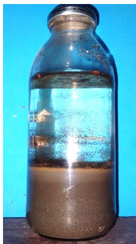
Figura 7. Cantidad de arena limo y arcilla de una muestra de suelo.
