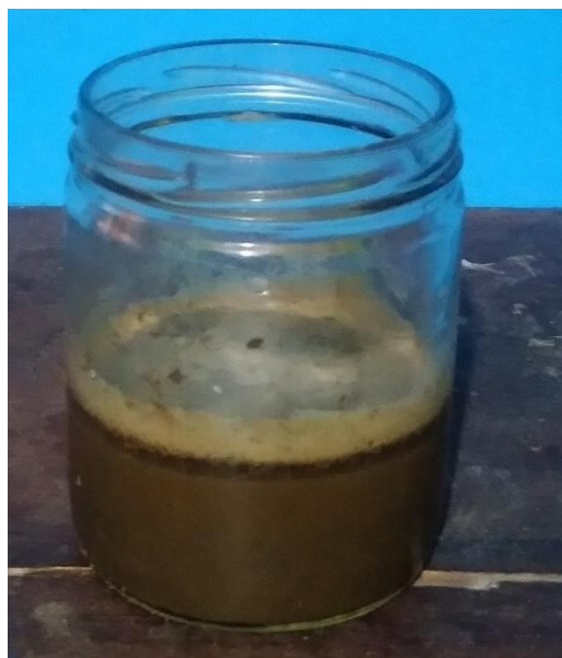
Figura 11. Muestra de suelo mezclada con vinagre.
