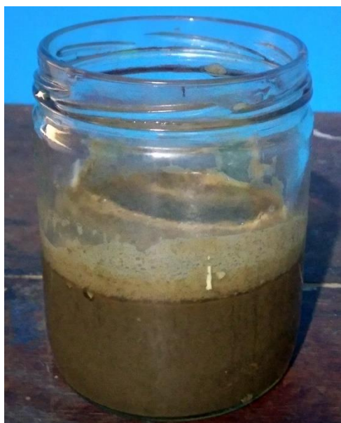
Figura 12. Muestra de suelo mezclada con bicarbonato de sodio.
