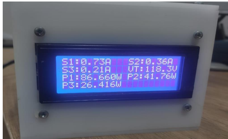
Figura 12: Pantalla lista para la instalación.
