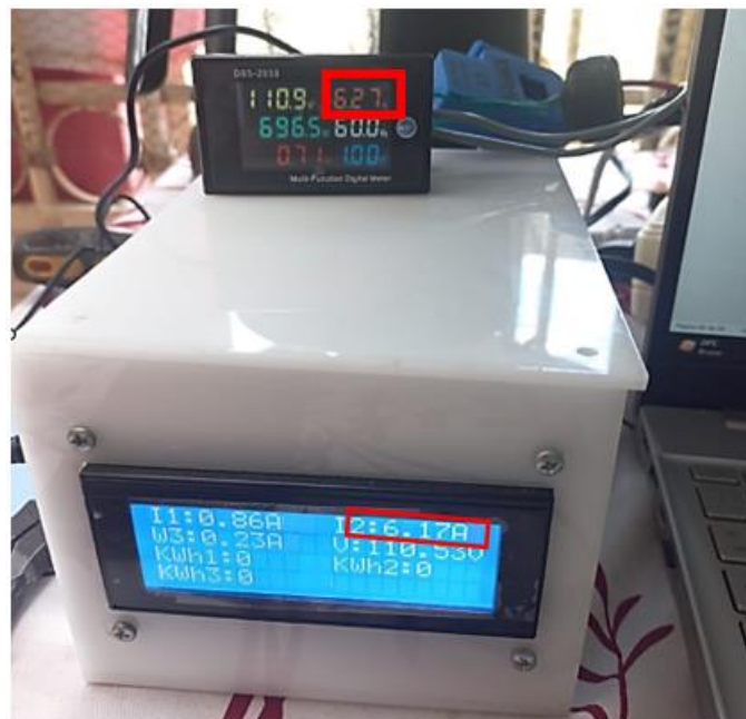
Figura 39. Prueba de medición en cafetera con dispositivo SENVOT ya calibrado
