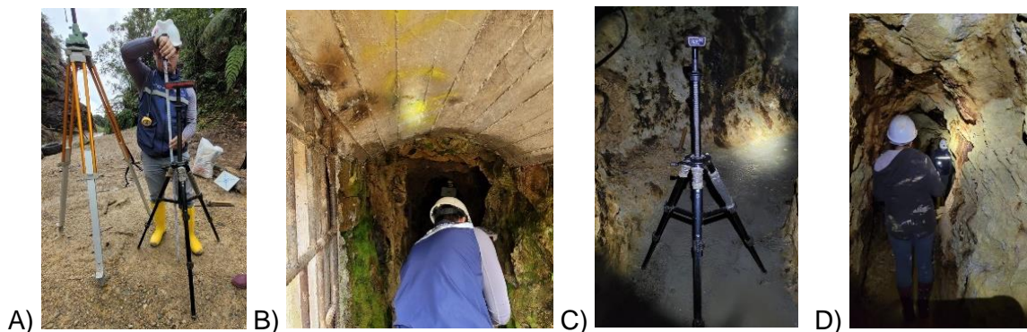
Figura 15. A) -B) -C) Preparación de equipos y ubicación de puntos con coordenadas conocidas en la Bocamina. D) Medición de distancias con distanciómetro, proyectando el láser hacia la diana topográfica.
