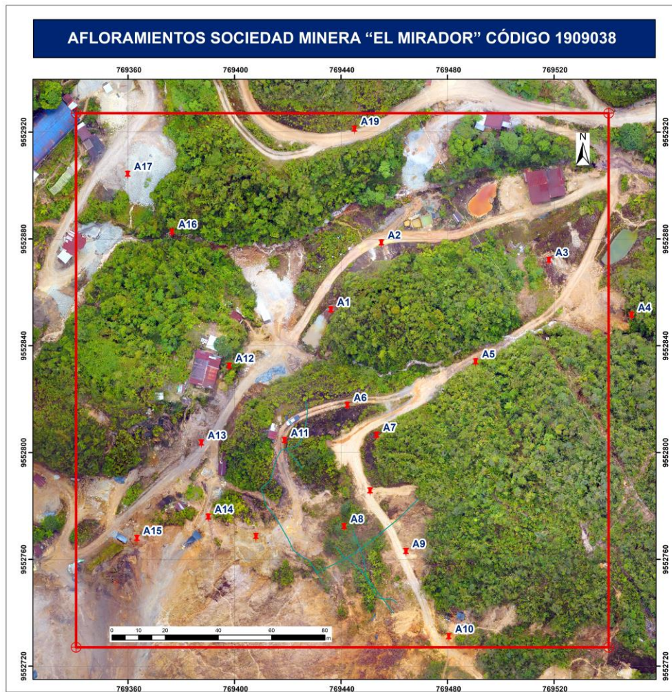
Figura 16. Planificación de puntos de afloramientos a describir in situ Datum WGS-84
