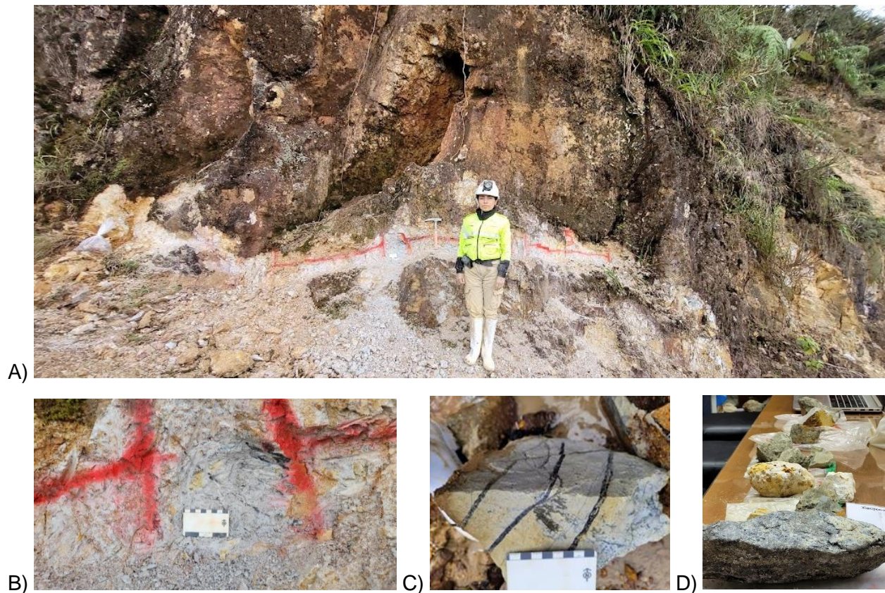
Figura 17. A) Método de canaleta para mapeo geológico B) -C) -D) Recolección y descripción petrográfica de muestras de mano
