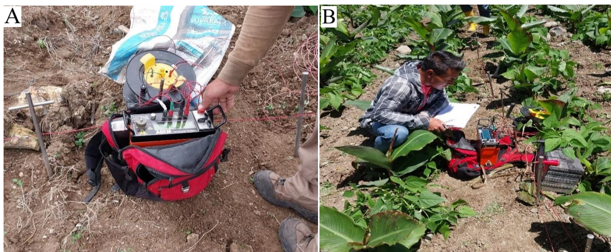
Figura 36. A) Equipo de resistividad eléctrica SAS-4000; B) Lectura de datos Insitu Nota. Elaborado por el autor, 2024
