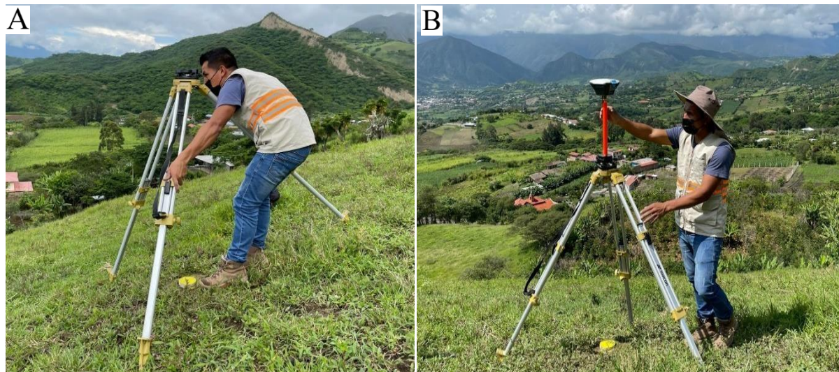
Figura 26. GPS diferencial A) Punto Base-nivelación de trípode; B) Ubicación de la Base Nota. Elaborado por el autor, 2024
