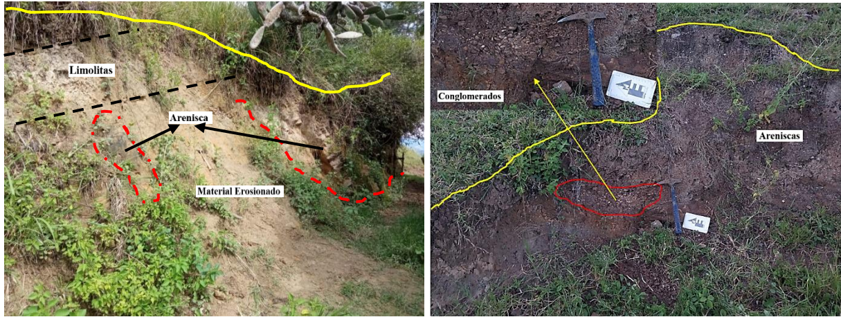
Figura 62. A la izquierda, afloramiento formado por limolitas y areniscas; A la derecha afloramiento formado por areniscas con un lente de conglomerado.
