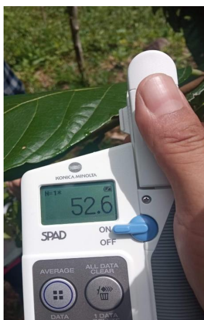
Foto 7. Medición de concentración de clorofila con equipo SPAD.
