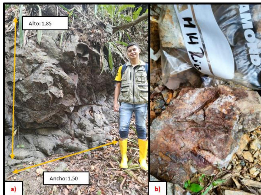
Figura 45. La figura a) indica el afloramiento de forma natural, con un grado de meteorización medio y en la figura b) se evidencia una muestra de roca metamórfica tomada en el mismo punto de muestreo, cerca de la rivera de la quebrada Inguna.
