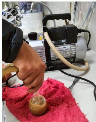
Figura 25. Succión de vacíos mediante bomba.
