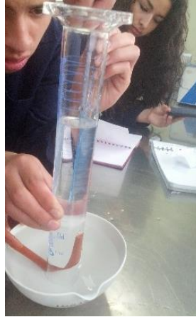
Figura 38. Desplazamiento del agua en la probeta.
