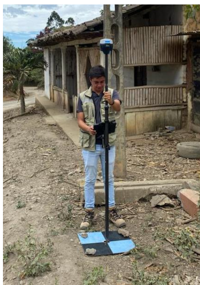
Figura 9. Puntos de apoyo para levantamiento fotogramétrico por percepción remota.
