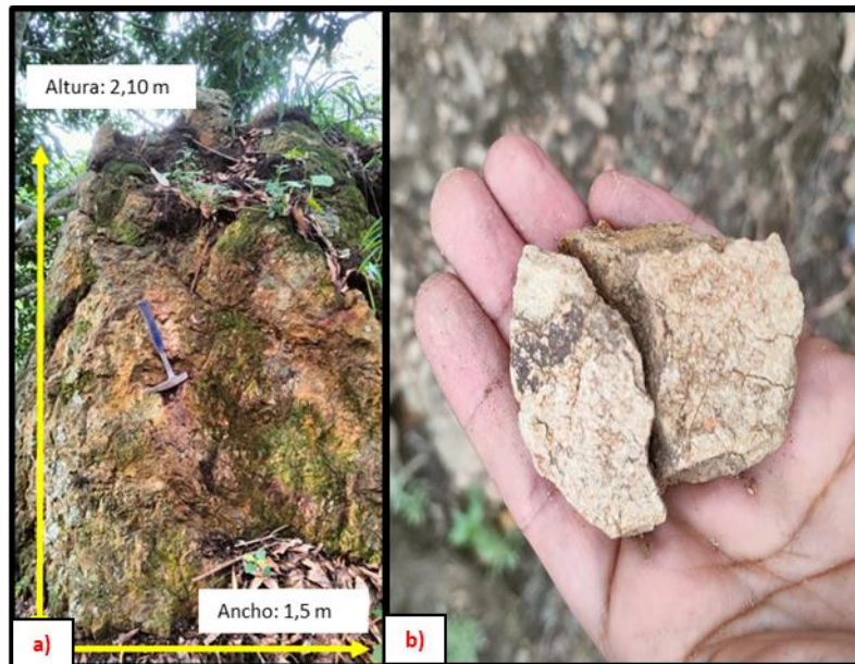
Figura 44. La figura a) muestra un afloramiento de lutita con grado de alteración media y la figura b) indica una fracción de roca del mismo punto de muestreo
