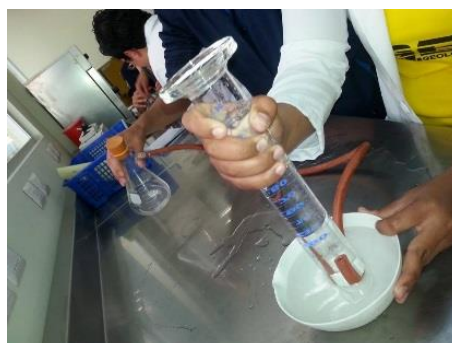
Figura 37. Reacción de la muestra con el ácido clorhídrico.
