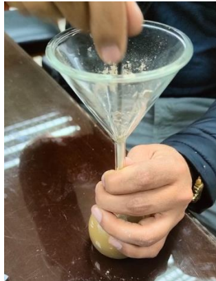
Figura 24. Introducción de muestra pulverizada en el picnómetro.
