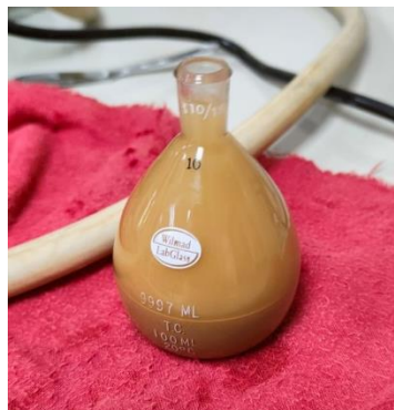
Figura 26. Picnómetro con muestra pulverizada y agua al 100%.
