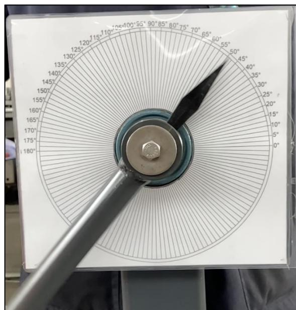
**Figura 15.** Escala graduada de la máquina de impactos
