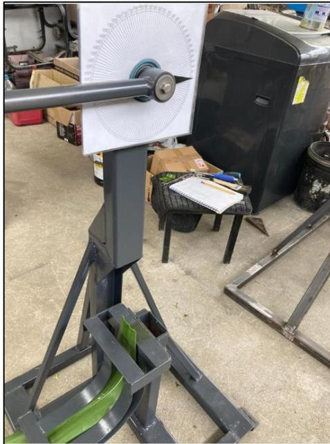
**Figura 13.** Péndulo de la máquina en posición inicial
