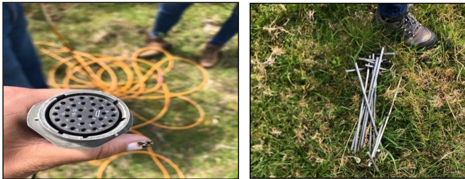
Figura 24. Fuente de conexión de corriente de los cables y electrodos metálicos.
