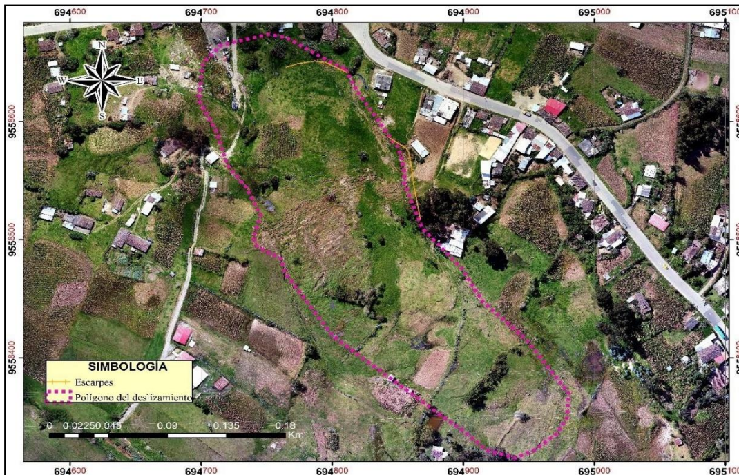
Figura 49. Deslizamiento traslacional, caracterizado en el área de interés
