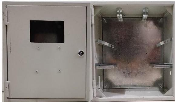
*Nota.* Parte externa e interna de la caja metálica del graficador de curvas I-V
