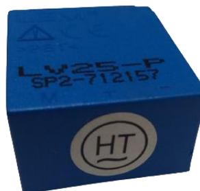
*Nota.* Es un sensor de voltaje industrial LEM específico para DC
