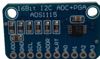
*Nota.* Convertidor de señales analógicas a digitales que tiene 8 frecuencias de muestreo que van desde los 8sps hasta 860sps.
