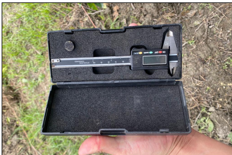
Anexo 4. Calibrador digital utilizado para recolectar los datos del diámetro del tallo de las plantas de café var. Castillo en la Quinta Experimental La Argelia.
