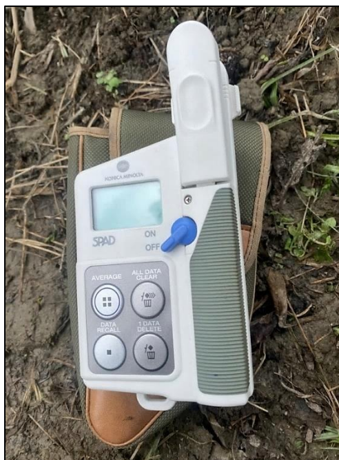
Anexo 3. Dispositivo SPAD 502 Plus utilizado para el registro de los datos de la clorofila de las hojas en las plantas de café var. Castillo en la Quinta Experimental La Argelia.
