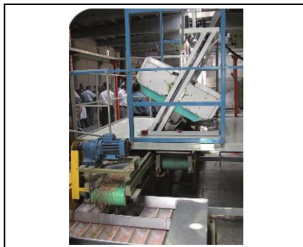
**Figura 5.** Clasificadora fotoeléctrica en una planta procesadora (Couceiro et al., 2013).
