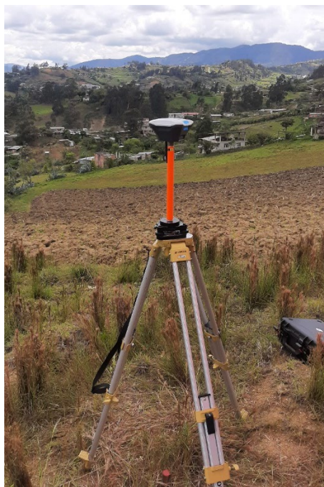
Figura 3. GPS diferencial (base fija)
