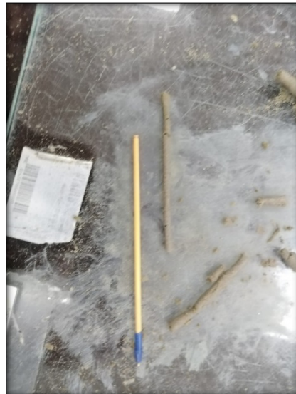
Figura 10. Ensayo de Límite Plástico
