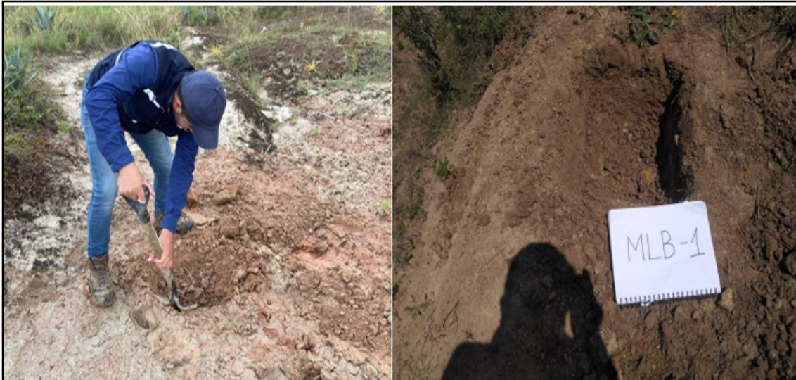
Figura 7. Toma de muestra para la clasificación de suelos
