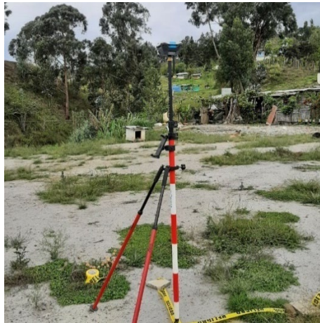
Figura 4. GPS diferencial (base colectora de puntos GSP)
