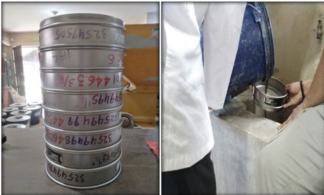
Figura 8. Proceso Análisis granulométrico
