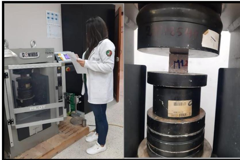
**Figura 20.** Ensayo de compresión simple.
