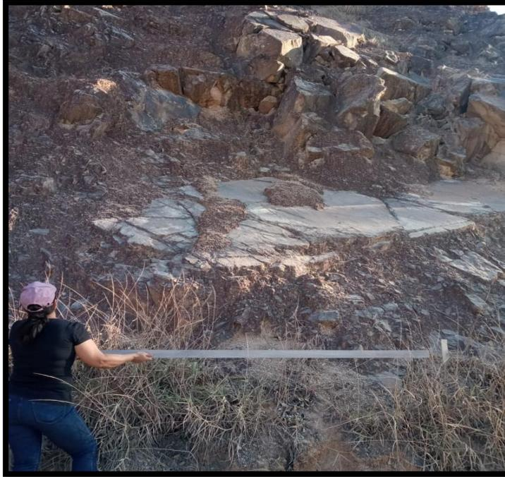
**Figura 22.** Aplicación de método de la regleta en campo.
