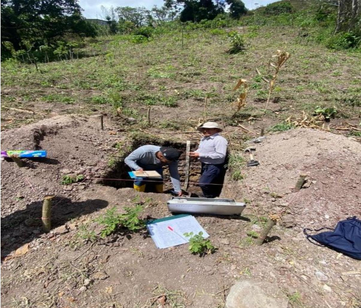
**Anexo 2.***Pruebas de infiltración.*
