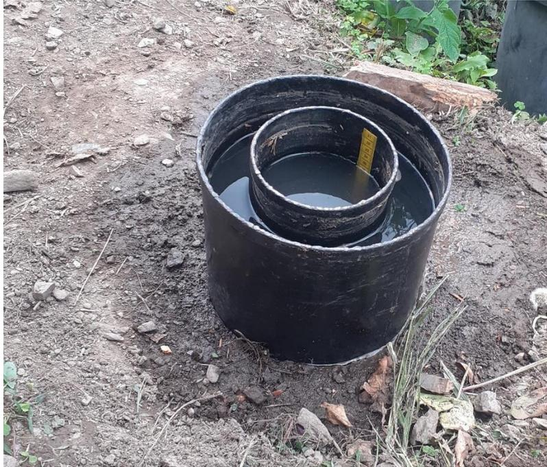
**Imagen 1.** Cilindro infiltrómetro simple.**Anexo 4.***Datos de infiltración del suelo*
