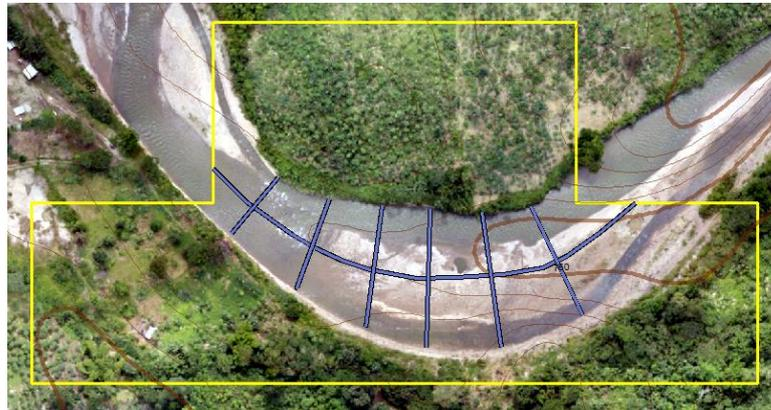
Figura 14. Batimetría: Medición longitud y ancho del segmento del Río Chuchumbletza que comprende el área de libre aprovechamiento GADMEP EL GUIISME. Elaboración por Herrera (2023).
