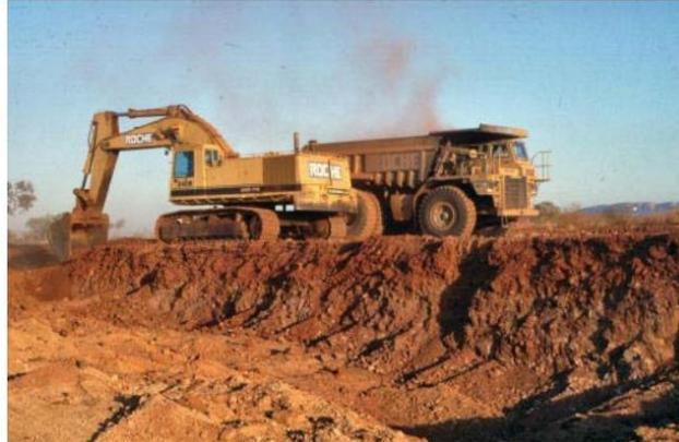
Figura 30. Extracción de material mediante graveras secas. Herrera Herbert (2006).
