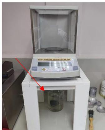
**Figura 44.** Determinación del peso sumergido.
