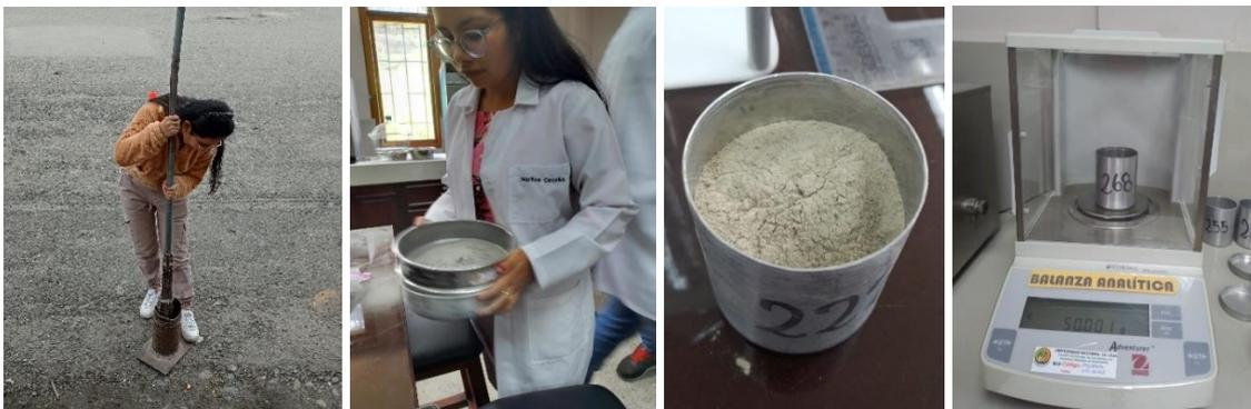
**Figura 45.** Preparación de la muestra para el ensayo del picnómetro.
