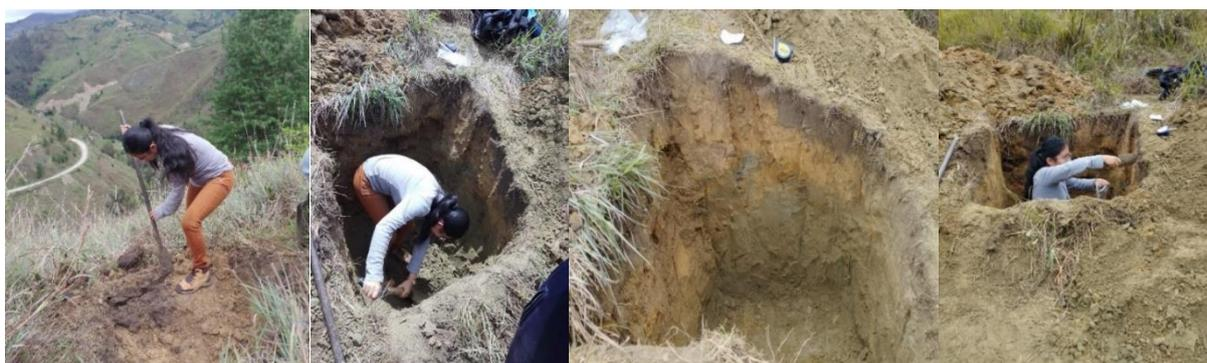
**Figura 24.** Procedimiento para la apertura de Calicata.
