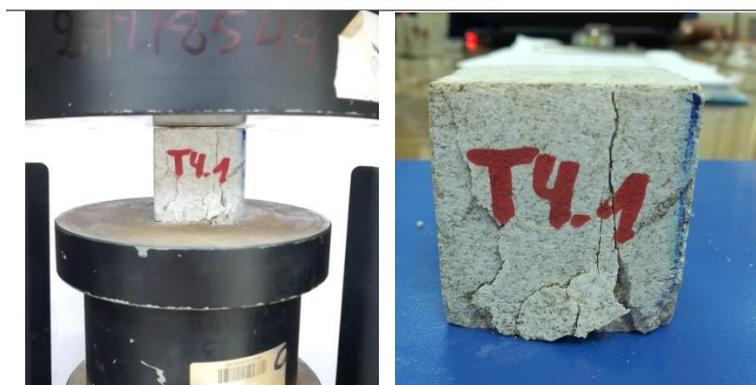
**Figura 108.** Cubos de roca del Talud de roca N° 4, después de aplicar la carga uniaxial.
