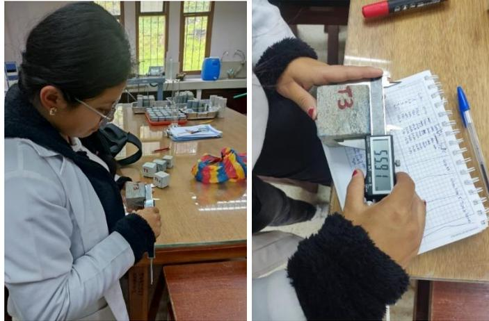
**Figura 39.** Toma de medida de las aristas de los cubos mediante un calibrador.
