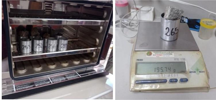
**Figura 42.** Determinación del peso seco.
