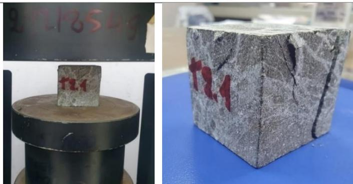
**Figura 102.** Cubos de roca del Talud 2, después de aplicar la carga uniaxial.
