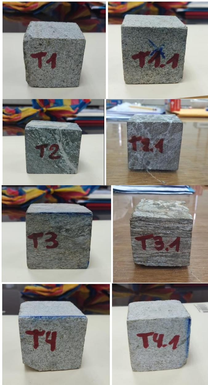
**Figura 38.** Muestras de cubos de los taludes de roca representativos N°1, N°2, N°3 y N°4.
