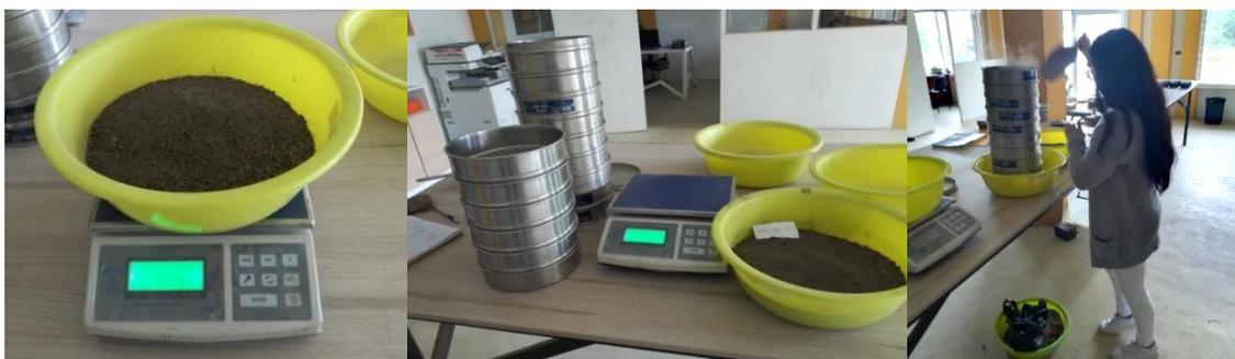
**Figura 26.** Análisis granulométrico.
