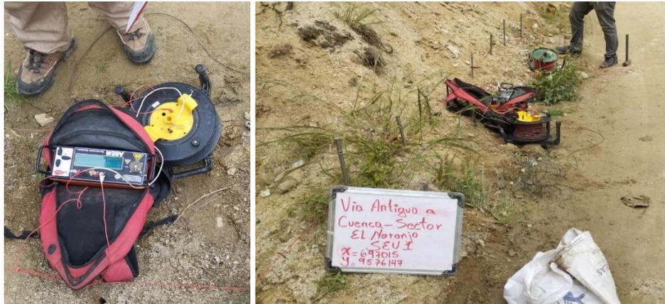
**Figura 22.** Equipo de resistividad eléctrica modelo Terrameter SAS 4000 (Izquierda), y disposición de electrodos en línea SEV2 (Derecha).
