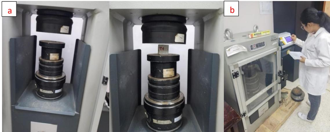
**Figura 40.** Ensayo de compresión simple.
