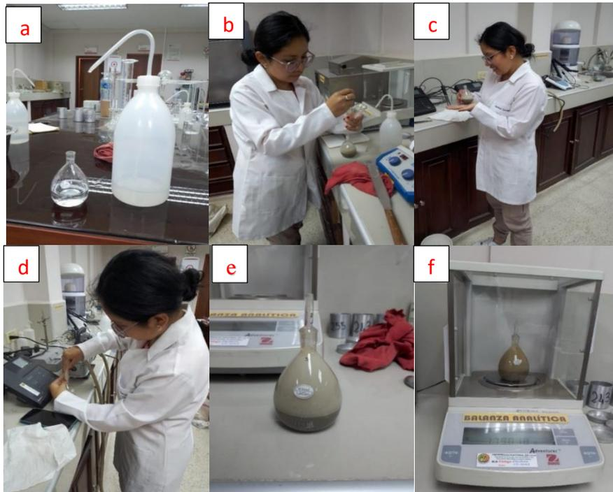
**Figura 46.** Procedimiento para el ensayo del picnómetro.
