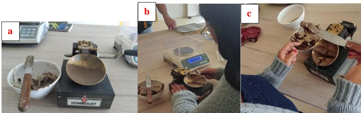
**Figura 28.** Determinación del límite líquido.
