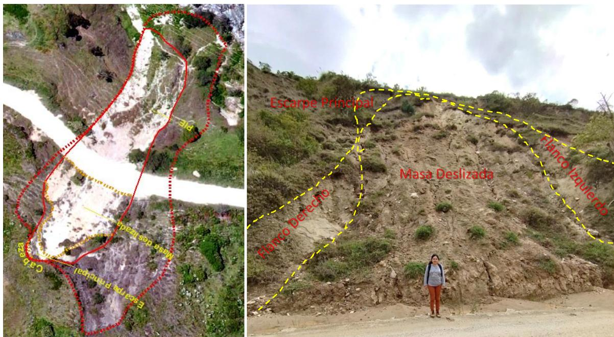
**Figura 82.** Deslizamiento MM8 formado por granodiorita.
