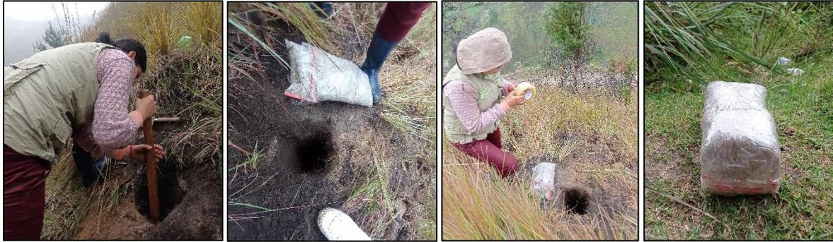
**Figura 31.** Extracción de la muestra para ser transportada a laboratorio.
