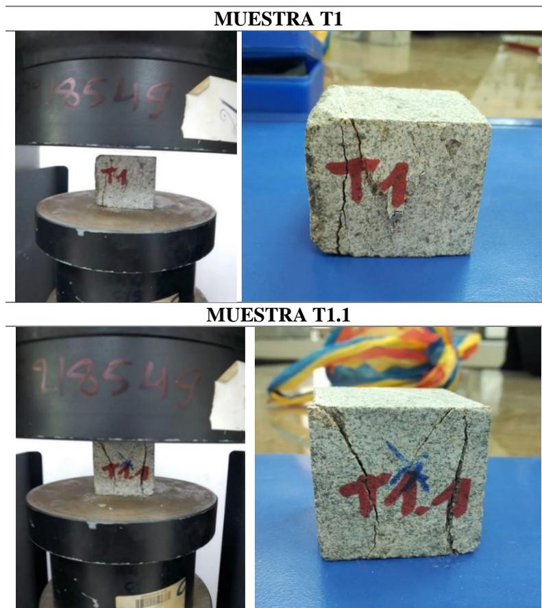
**Figura 99.** Cubos de roca del Talud de roca N° 1 después de aplicar la carga uniaxial.
