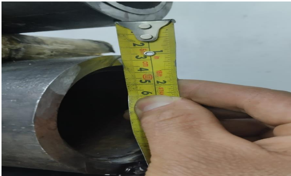
Figura 85. Medición manual de la separación entre masas.
