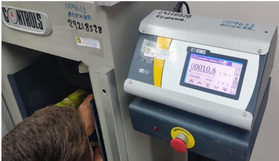
Figura 87. Fuerza obtenida al reducir la caña a 5mm de un diámetro inicial de 54 mm.
