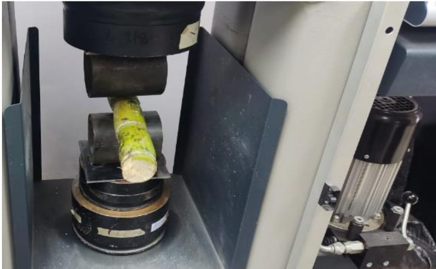
Figura 32. Proceso experimental del aplastamiento de la caña.
