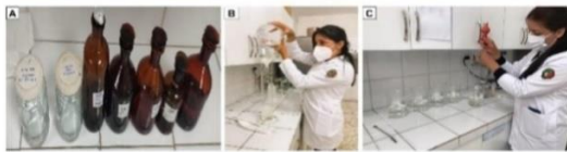
Fig. 2. Preparación del medio de cultivo MS-1962 + KIN y BAP. A) Soluciones minerales del medio de cultivo MS-1962. B) Adición de vitaminas. C) Adición de vitaminas reguladores de crecimiento.
