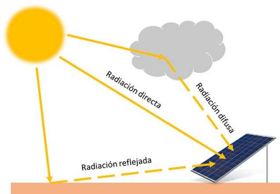
*Nota.* En el grafico se observa los componentes de radiación solar. Tomado de Oscarmtznarva.(2020)
