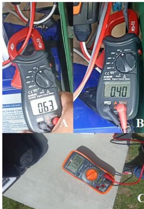
*Nota.* El literal A corresponde a la medición de corriente que demandan las luminarias, el literal B se muestra la corriente demandada por dos celulares y un computador de 50 W, mientras que el literal C muestra el voltaje usado por las cargas.
