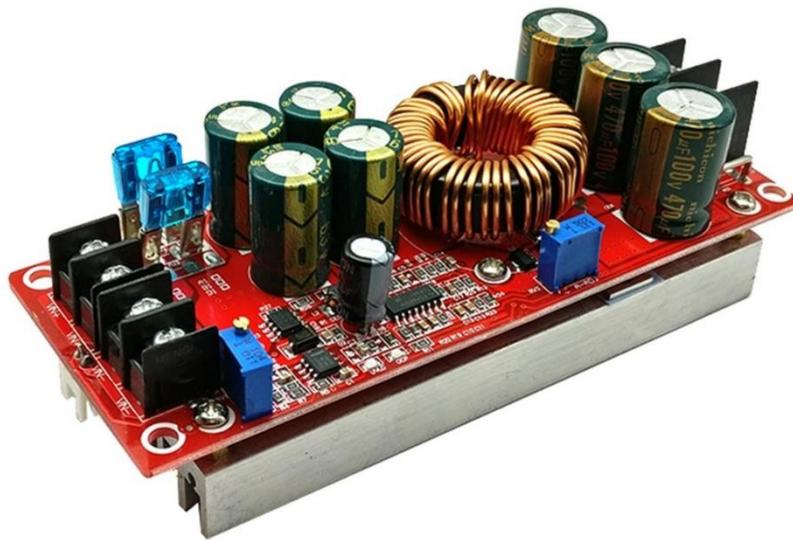
**Figura 48.** Módulo elevador de voltaje dc-dc
