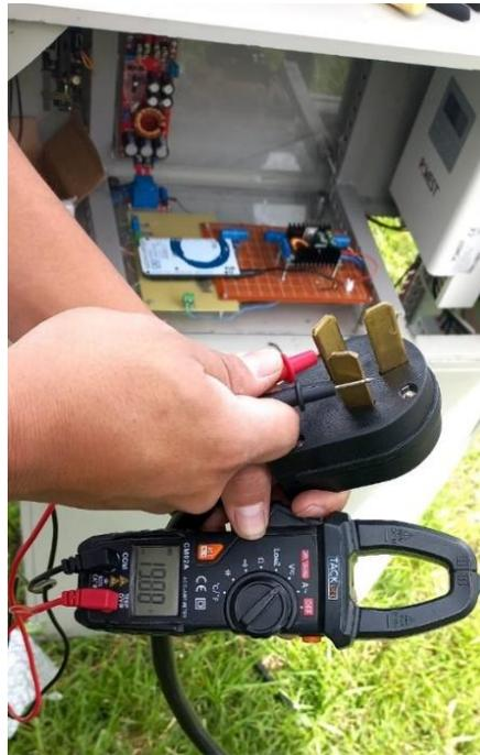
**Figura 43.** Medición de valor de voltaje en dc, salida de matriz FV.
