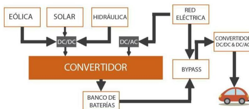
**Figura 1.** Elementos que conforman una electrolinera.
