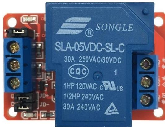
**Figura 47.** Módulo relé 5V, 10A.
