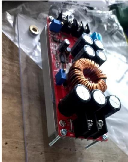
**Figura 35.** Implementación de los elevadores de voltaje en la base de acrílico.
