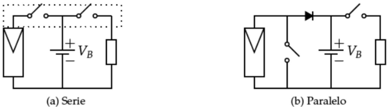
**Figura 13.** Esquema eléctrico de un regulador de carga.
