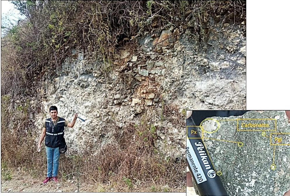
Fotografía 10 Andesitas verdes con textura afanítica y presencia de carbonatos, en la vía al sector Cabuyal (UTM: 662860E, 9513309N.)
