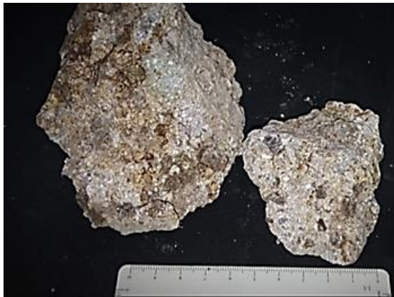
Fotografía 18 Aglomerado volcánico meteorizado (UTM: 664007E, 9510935N, H:1773m.)
