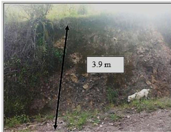
Fotografía 19 Afloramiento de aglomerado volcánico meteorizado (UTM: 665182 E, 9510761N, H:1532.)
