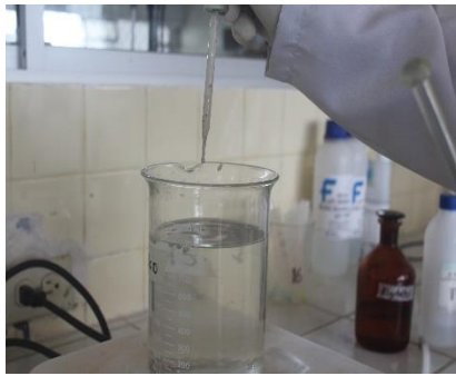
Dejar caer gota a gota en la solución de cloruro de calcio
