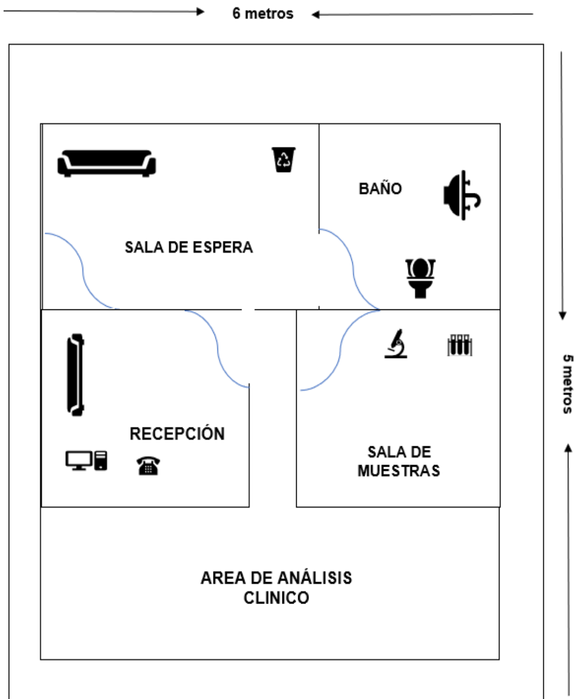
Figura 31. Distribución de la planta del laboratorio Granda
