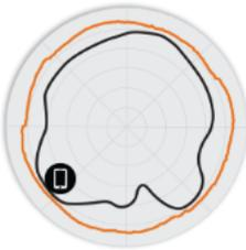
Figura 3. T310d 5 GHz: patrones de antena en acimut
