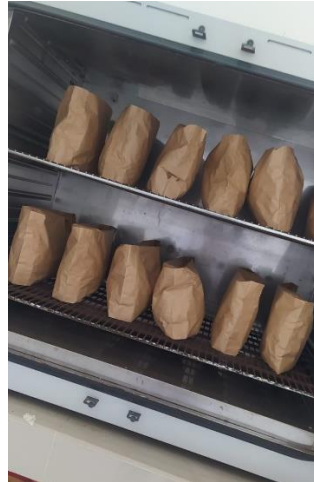
Figura 5. Secado de las muestras de hojarasca en laboratorio
