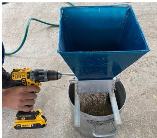
**Figura 3.** *Molturación de malta base con molino de rodillos*
