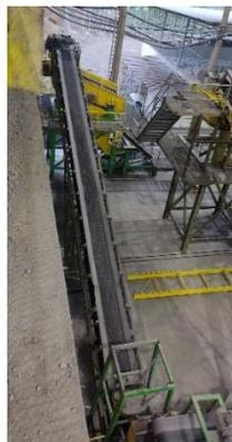
**Figura 4.** Banda transportadora a la salida de la trituración primaria hacia la secundaria, lugar donde se realizó el muestreo para las pruebas de flotación.
