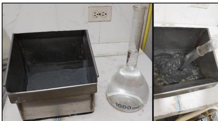
Figura 13. Preparación de densidad de pulpa al 30 % de sólidos.
