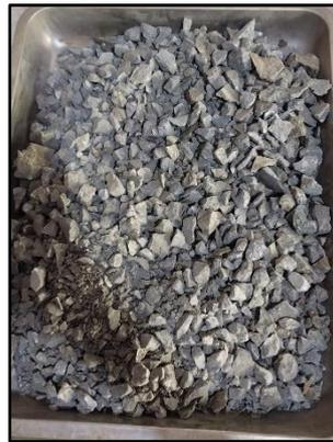
**Figura 11.** Material obtenido de la trituración primaria.
