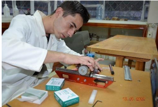
Figura 7. Cortes anatómicos de los núcleos de madera en el Laboratorio.
