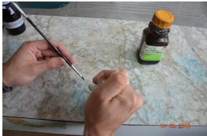
Figura 9. Sellado permanente de las muestras de los núcleos de madera.
