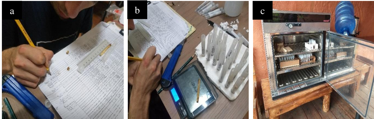
Figura 6. Medición, pesado y secado de los núcleos de madera. a. Medición de la longitud del núcleo de madera. b. Pesado del núcleo de madera. c. Secado del núcleo de madera.
