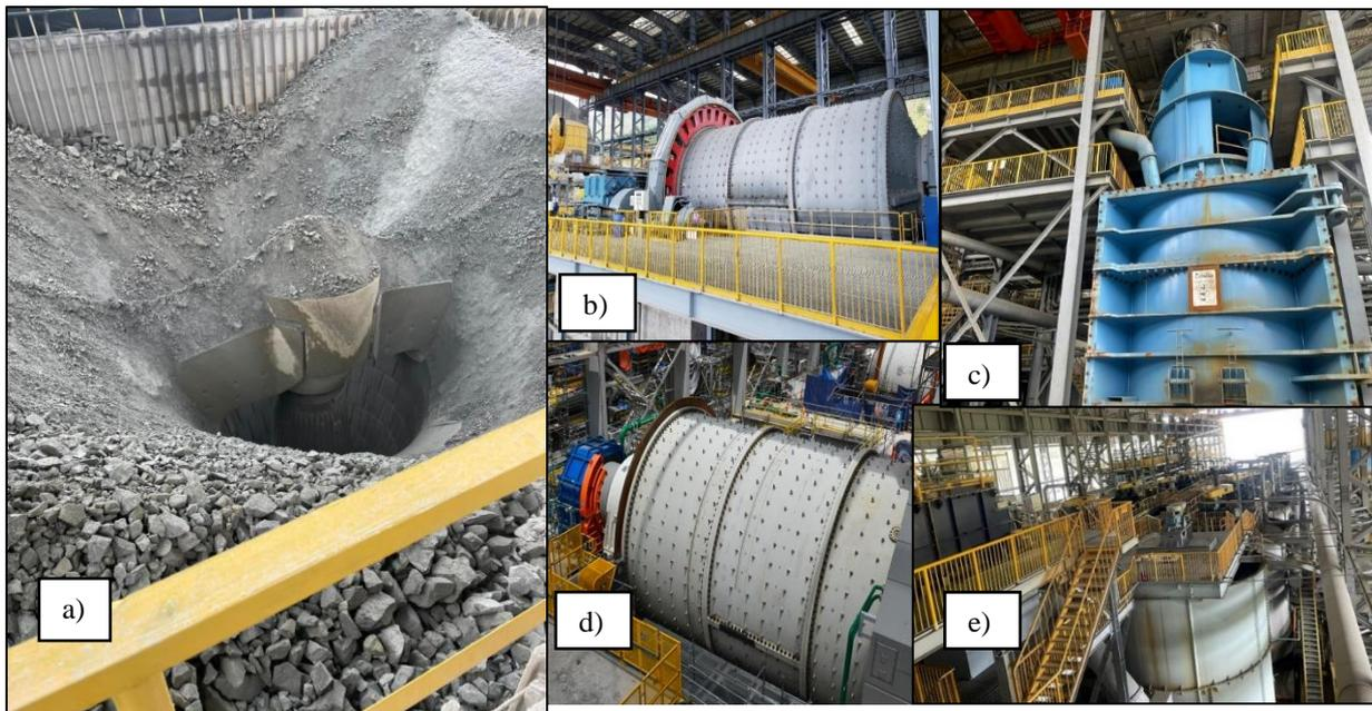
**Figura 14.** a) Trituradora giratoria, b) molino SAG, c) Trituradora de guijarros, d) Molino a bolas e) celdas serranas de flotación
