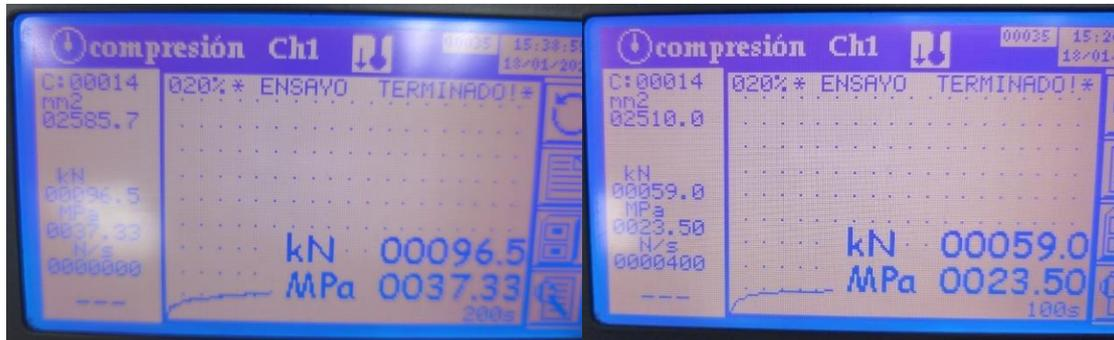
**Figura 19.** Resultados resistencia a la compresión simple
