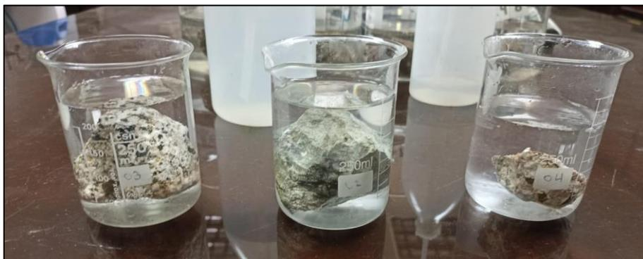
**Figura 8.** Peso específico aparente
