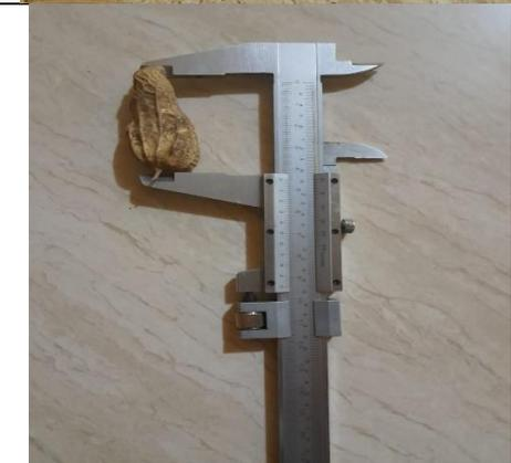
**Figura 22.** Toma de datos de diámetro y longitud de la semilla
