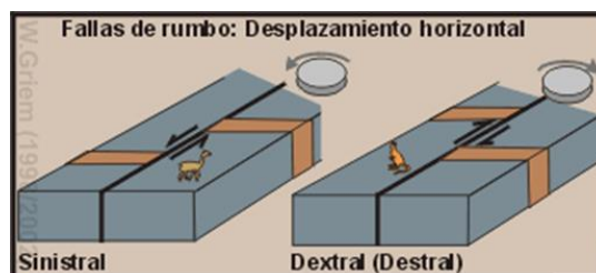
Figura 11 Fallas de rumbo Nota: Griem (2020)
