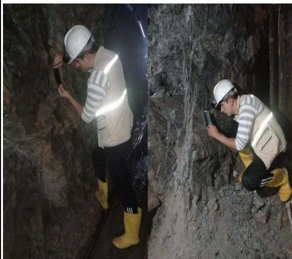
Fotografía 32. Toma de la Rugosidad con el Peine de Bartom.
