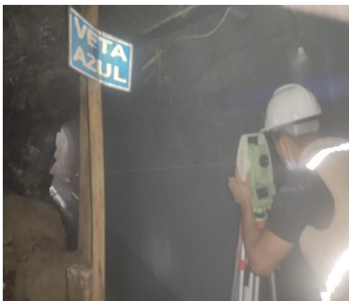
Levantamiento interior mina.
