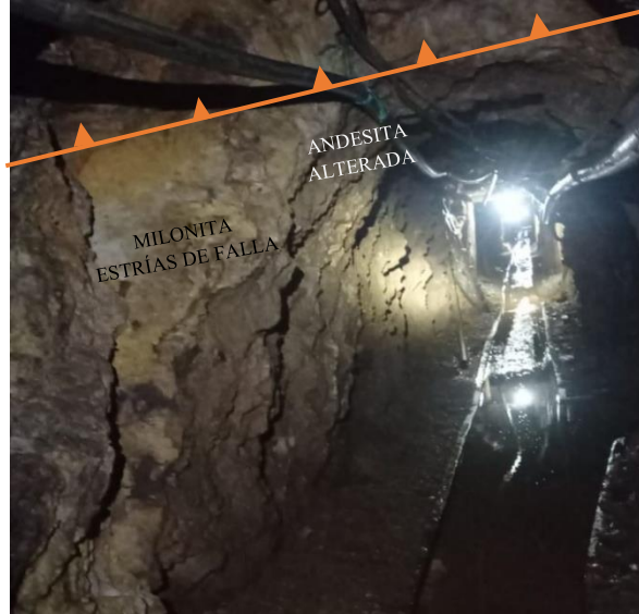
Fotografía 13. Falla inversa de 0.5 m de salto de falla con andesita alterada.
