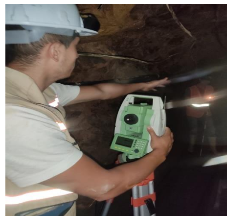
Levantamiento por poligonal Abierta
