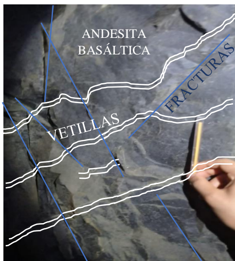
Fotografía 20. Andesita basáltica de textura afanítica con vetillas, en el tramo P36-P38
