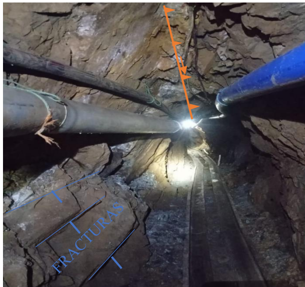
Fotografía 17. Falla inversa en el P19, con un salto de falla de 30 cm.
