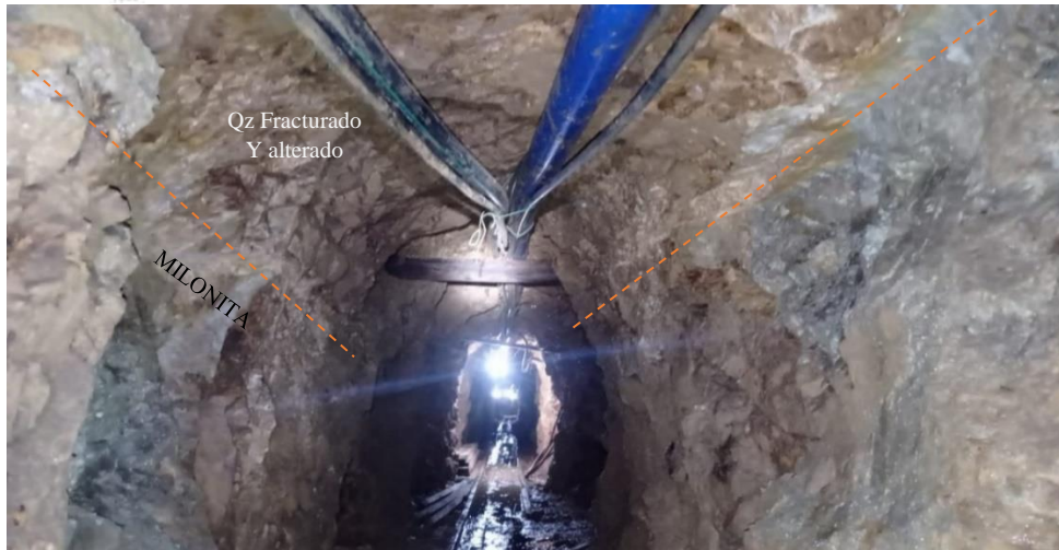
Fotografía 14. Falla INFERIDA entre la veta F y la veta A , con presencia de milonita y cuarzo alterado.
