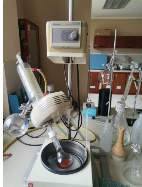
Anexo 12. Preparación de muestra y rotavaporación
