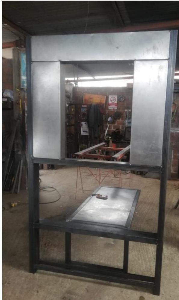
a) Soporte principal de la estación solar en construcción.
