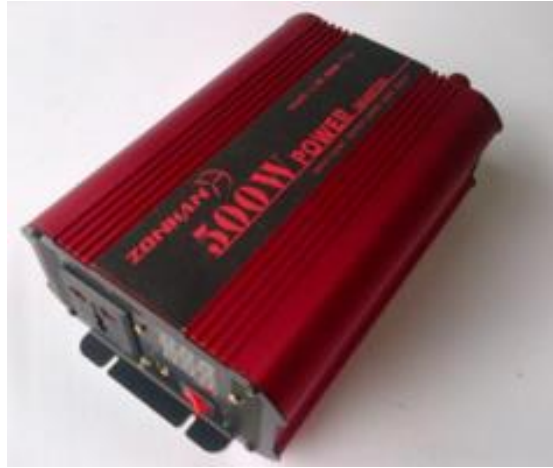
Figura 6. inversor de corriente DC/AC. Fuente: Autor
