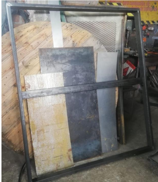
b) Base de los paneles solares en construcción
