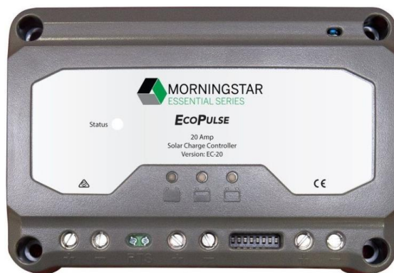
Figura 4. Controlador Solar. Fuente: Autor
